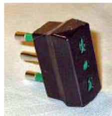
Per il sovraccarico bisogna porre molta cautela anche utilizzando degli **adattatori tripli** (nella foto un tipo vecchio e pericoloso), che consentono l'inserimento di 3 spine da 10 A in una presa da 10 A, e quindi un assorbimento teorico di **30 A**.
